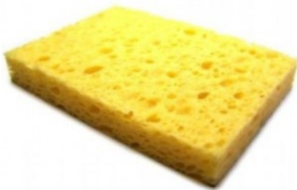
Fig.1 – Esponja vegetal para limpeza da ponta do ferro de solda
